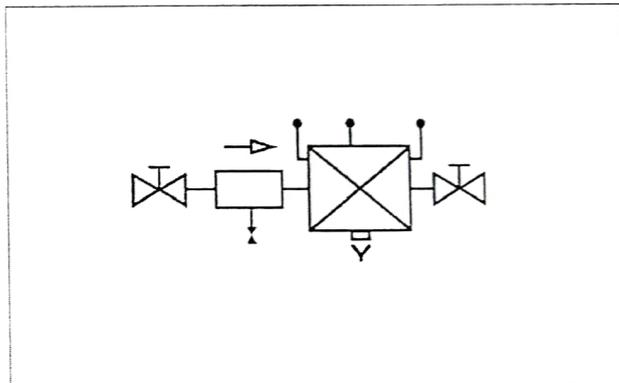
Bild 3: Sicherungseinrichtung Graphisches Symbol
